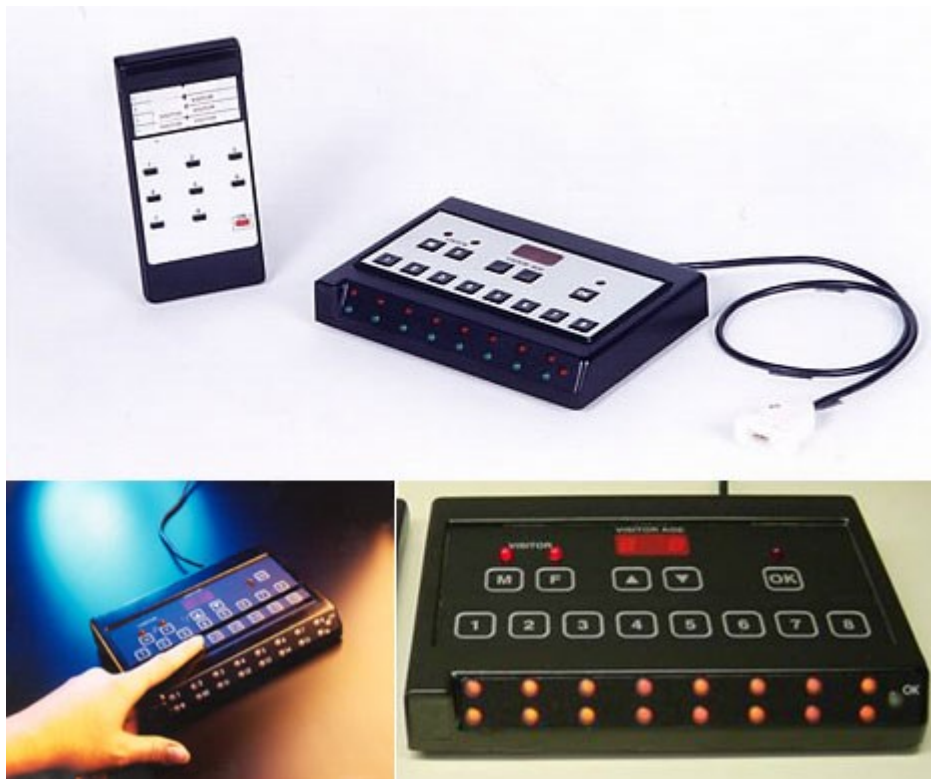
Uređaj za merenje gledanosti - piplmetar
